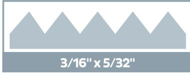
El tamaño de la llana es sugerida para maximizar la cobertura de la membrana. Revise periódicamente la cobertura durante la instalación: se requiere 100% de cobertura. Sub-suelos desnivelados pueden necesitar el uso de un material de parchado/nivelación o una llana de muesca en V más grande para la cobertura apropiada.
